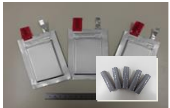
正負極とも水系電極を用いた積層型・円筒型LiBセル
