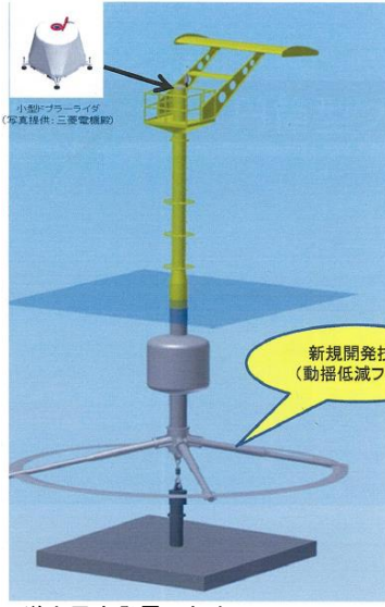
洋上風力発電のための低動揺ブイ式観測システム(NEDO事業)
